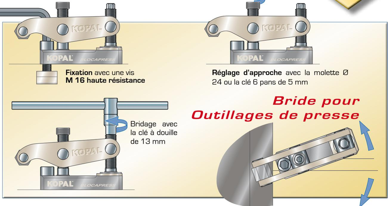
Fixation avec une vis M 16 haute résistance
